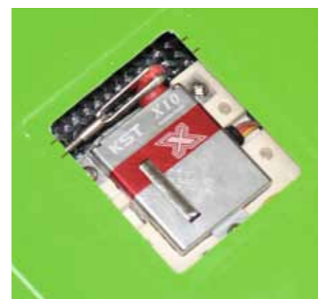
Damit die Gestänge beim Verkleben der Servorahmen auch exakt fluchten, haben wir die Lage der Anlenkungsgestänge mit einem Marker angezeichnet
