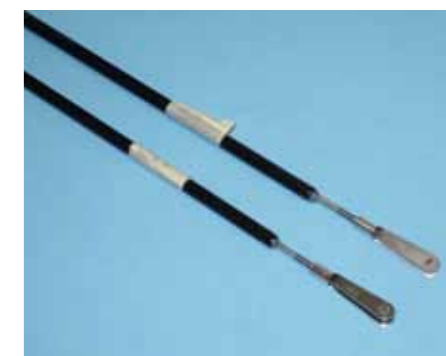
Die Anlenkungsgestänge werden mit Uhu Plus in den CFK-Rohren verklebt
